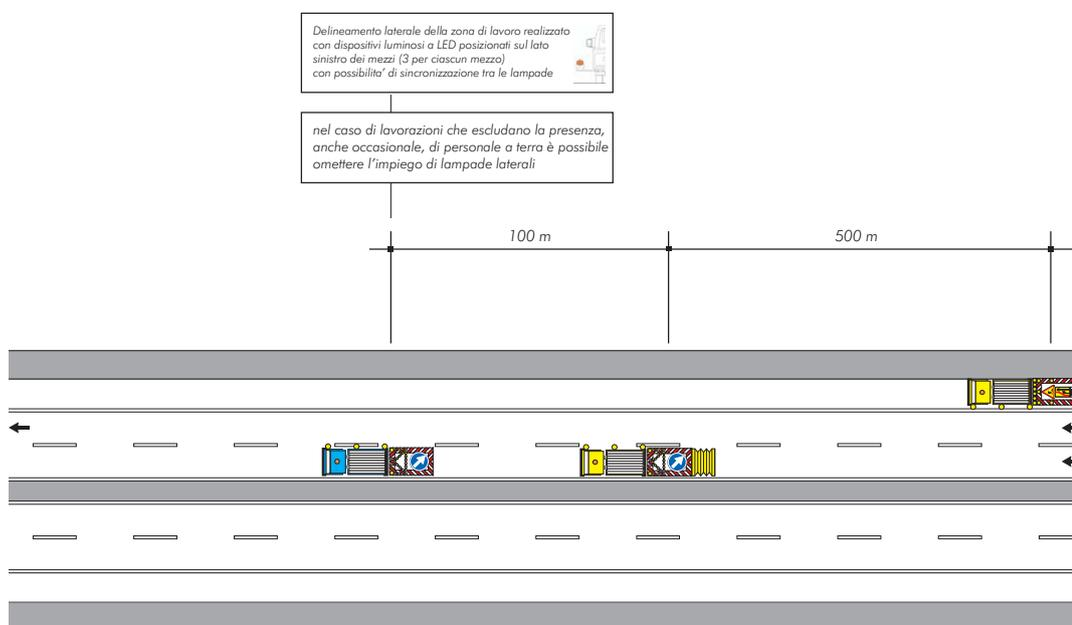
**SEGNALETICA MOBILE A PROTEZIONE DI VEICOLI SPECIALI IMPIEGATI PER LAVORI, CONTROLLI, SONDAGGI E VERIFICHE DI RAPIDA ESECUZIONE, CHIUSURA DELLA CORSIA DI SORPASSO (CARREGGIATA CON CORSIA DI EMERGENZA RIDOTTA)**
