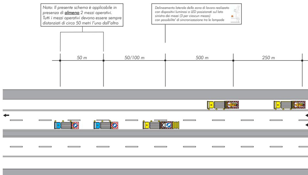
**CANTIERE IN LENTO AVANZAMENTO, CHIUSURA DELLA CORSIA DI SORPASSO (CARREGGIATA CON CORSIA DI EMERGENZA RIDOTTA)**
