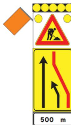
Figura 13: "presegnale di cantiere mobile" fig. Il 399/a Art.39 Reg., da impiegare su tratti autostradali con corsia di emergenza ridotta per la chiusura di una o più corsie di transito (la figura esemplifica la chiusura della corsia di marcia in dx). E' integrato con set di 5 lampade a led ad alta efficienza luminosa diam. 200 mm (con possibilità di lampeggio sincrono e sequenziale) e con sbandiatore elettromeccanico posto in alto sul lato esposto al traffico.
