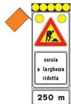
Figura 15: "presegnale di cantiere mobile" derivato dalla fig. Il 399/a Art.39 Reg., da impiegare per lavori sulla sola corsia di emergenza ridotta. E' integrato con set di 5 lampade a led ad alta efficienza luminosa diam. 200 mm (con possibilità di lampeggio sincrono e sequenziale) e con sbandiatore elettromeccanico posto in alto sul lato esposto al traffico.
