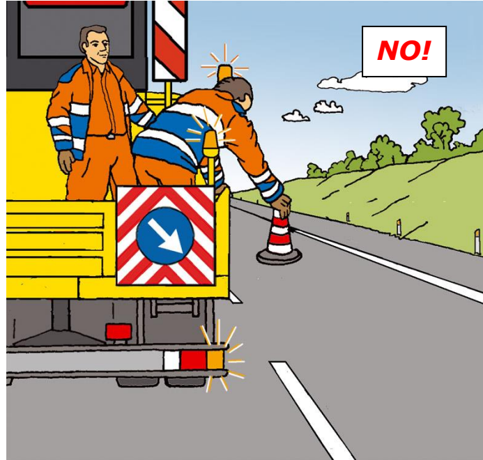
Figura 45 – Posizionamento dei coni o defleco: comportamento scorretto
