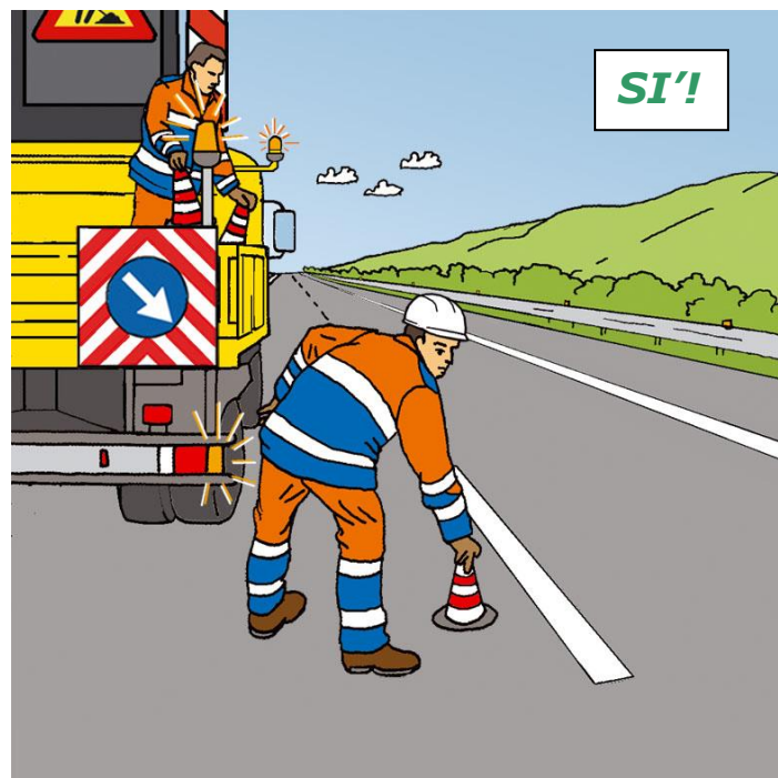
Figura 44 – Posizionamento dei coni o defleco: comportamento corretto
