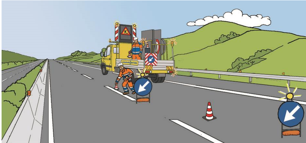
Figura 32 – Chiusura della corsia di marcia: inizio della posa dei coni
